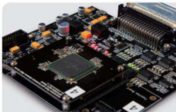
車輛系統控制器（新能源汽車用） Vehicle System Controller (for NEVs)
