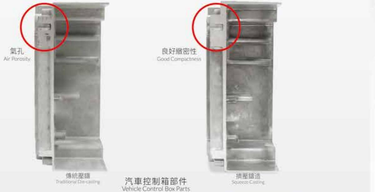
新型擠壓鑄造成型技術，是將液態金屬注入壓室，由下往上低速層流，高壓補縮的填充方式，凝固成形，消除鑄件內部的縮孔，疏鬆等缺陷，使鑄件致密、外觀優良，獲得組織致密，機械性能高的鑄件。擠壓鑄造技術保留傳統壓鑄技術的特點，高效、低成本等優勢，並解決壓鑄件力學性能差，不能熱處理等問題，實現：以輕合金代替黑色金屬，有利於汽車輕量化的發展。為汽車、軌道交通輕量化結構件，提供最優質的解決方案。
